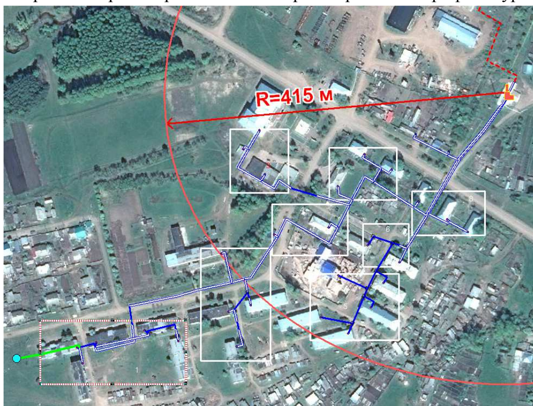
Рисунок 6.2 – Эффективный радиус (расстояние до потребителя) теплоснабжения, от котельной.
