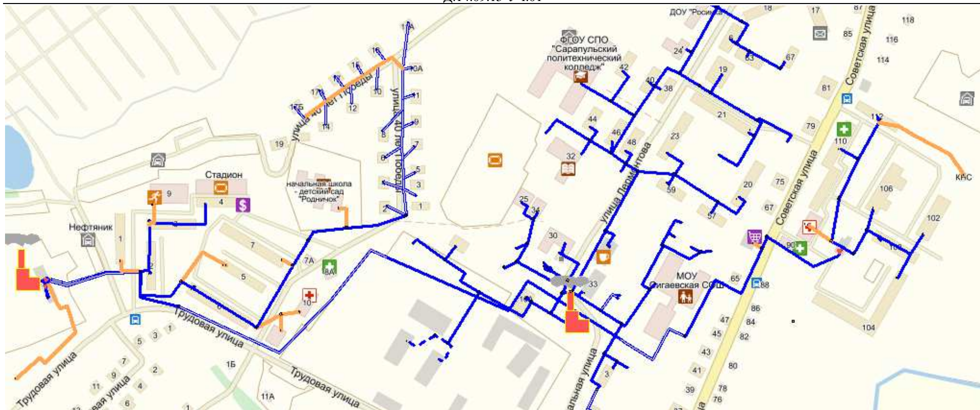
Рисунок 5.2 – Предлагаемые участки под замену (выделены оранжевым цветом) в связи с несоответствием пропускной способности трубопроводов.
