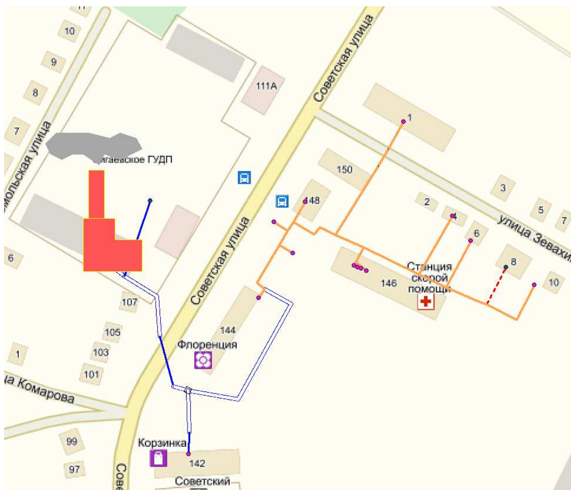
Рисунок 5.3 – Предлагаемые участки под замену (выделены оранжевым цветом) в связи с несоответствием пропускной способности трубопроводов.
