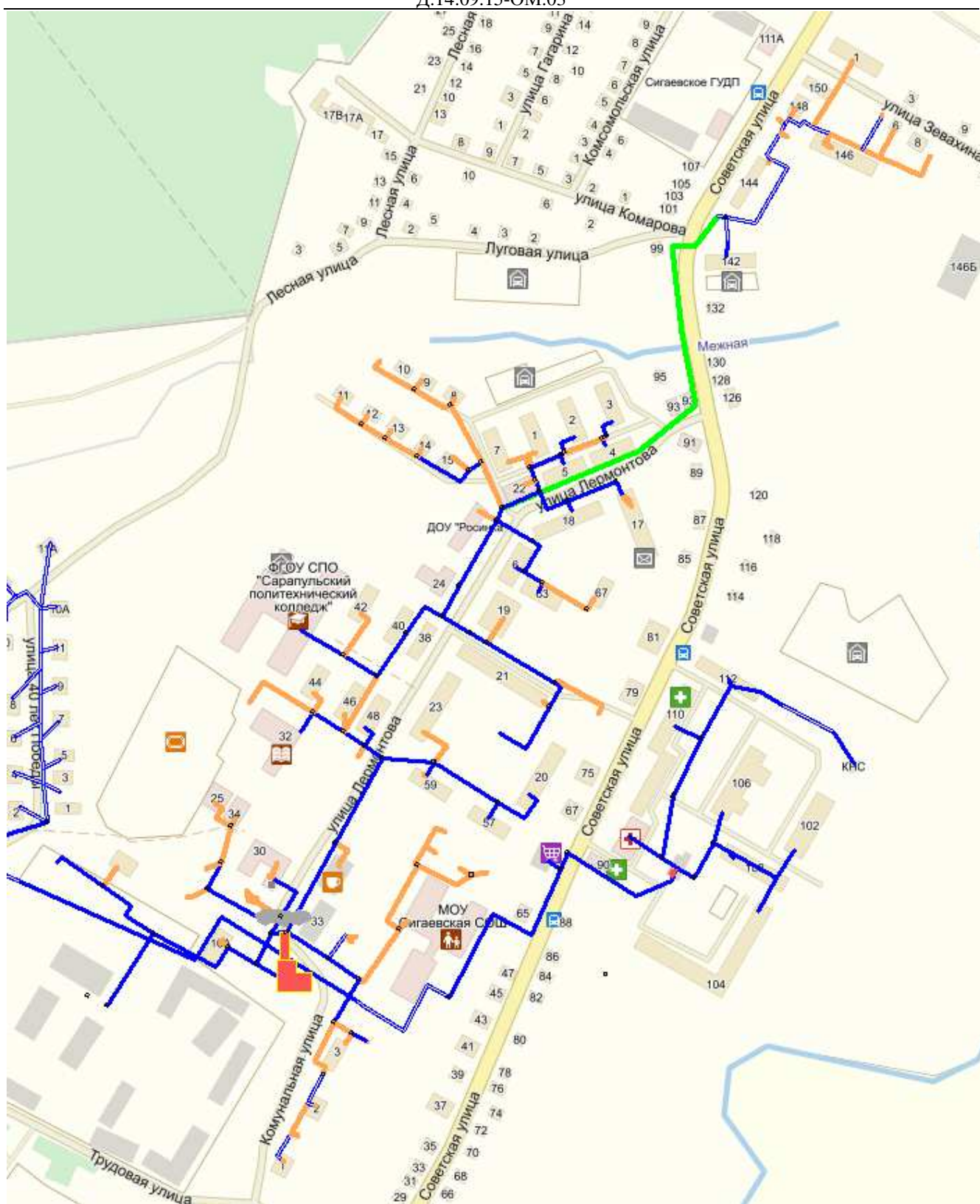
Рисунок 7.4 – Предлагаемые участки под замену (выделены оранжевым цветом) в связи с несоответствием пропускной способности трубопроводов.
